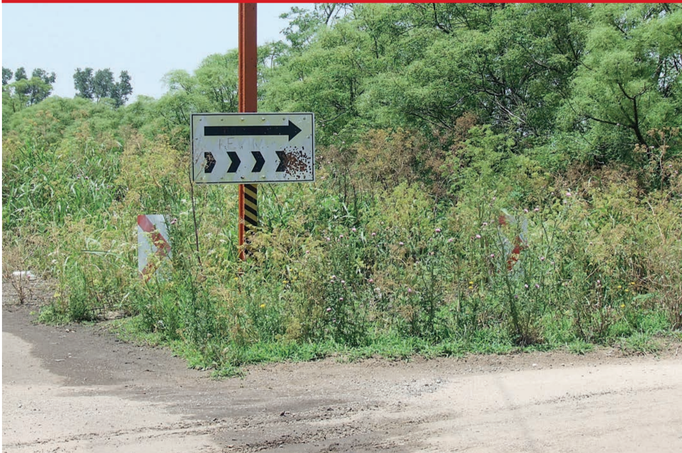
Avenida 51 bis (ex ruta 94): Curva a 90 grados y señales obstruidas por pastizales.
