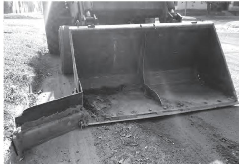
en la lonja del ferrocarril en la zona este de Villa Cañas, como así también comenzó a implementarse un eficiente sistema de barrido del cordón cuneta, en el que se aplicó un dispositivo, íntegramente construido por personal municipal, a la pala frontal existente. Para optimizar este trabajo, también se agregará un cepillo.
